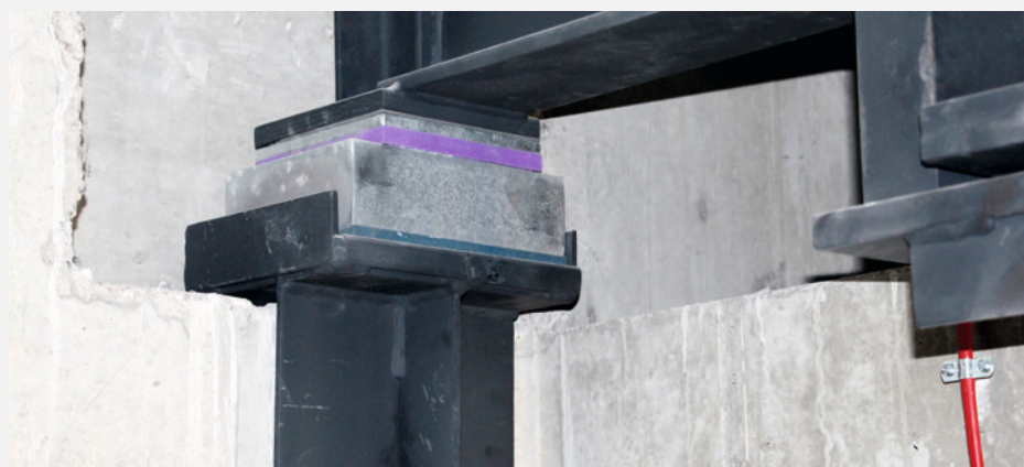
Dwustronnie sprężyste łożyskowanie izolatorami Isotop® SE-DE, bęben liny w górnej części szybu
