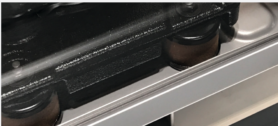
Łożyskowanie zespołu sprężarkowego izolatorami Isotop® MSN-DAMP
